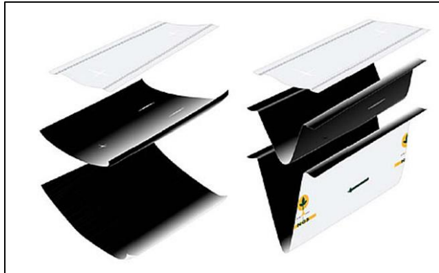
Figura 1. Láminas de polietileno superpuestas en forma de "V".
