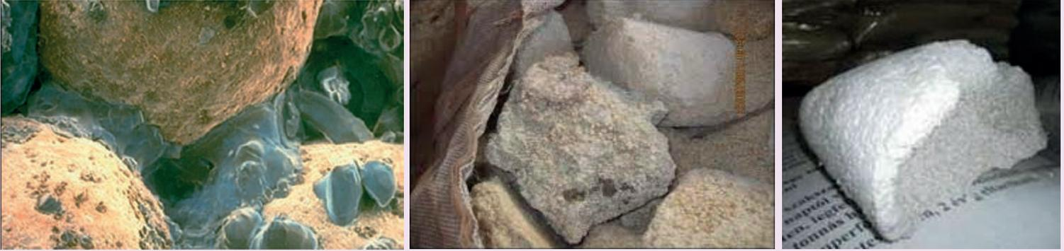
Puentes cristalinos entre partículas de fertilizantes causando apelmazamiento
