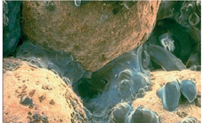
Puentes cristalinos entre partículas de fertilizantes causando apelmazamiento
